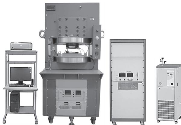
▶2.7T発生250°C温度測定可能 B-Hカーブトレーサ構成例
