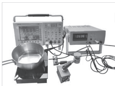
測定例: 電磁調理器の漏れ磁場測定
