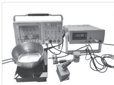
測定例：電磁調理器の漏れ磁場測定
