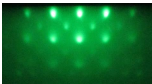
図 1. \text{MgO}(100) 上の \text{Sn}_x\text{Fe}_{3-x}\text{O}_4 エピタキシャル膜の [100] 方向の RHEED 像
