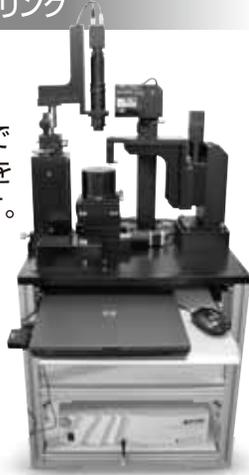
振動試料型磁力計 VSM
