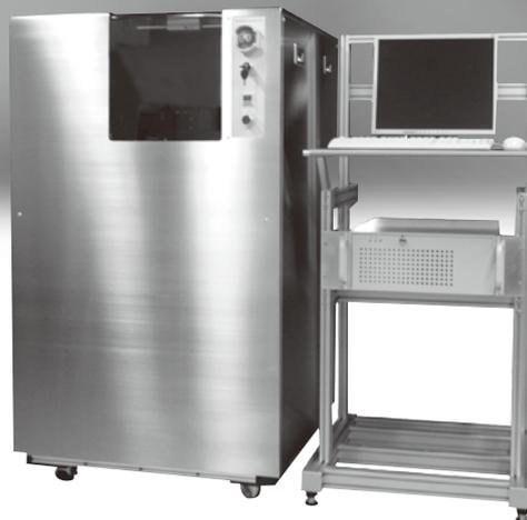
空間光変調器 DMD (Digital Micromirror Device) を用いたパターン縮小投影技術で、最小画素  $1\mu\text{m}$  にて自由度の高いパターン描画を実現。
