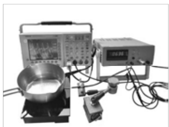
測定例: 電磁調理器の漏れ磁場測定
