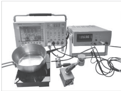
測定例: 電磁調理器の漏れ磁場測定
